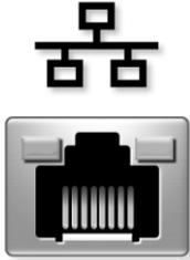
Conecta el ordenador a una red. Los indicadores luminosos del conector indican la actividad de las comunicaciones de red con cable e inalámbricas.
